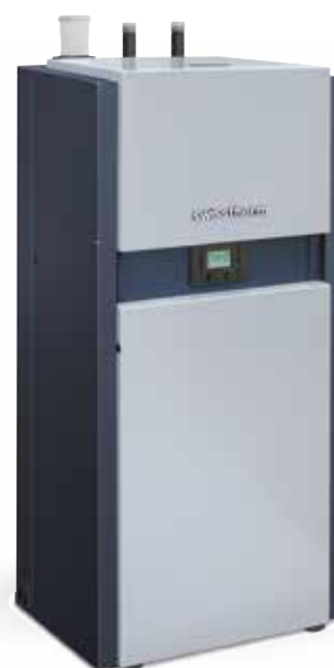
Kompakter Öl-Brennwert-Kessel «VARIO CONDENS» von Swisstherm. Alles integriert, sparsamer LowNox Sturzbrenner, Kesselkreispumpe für gleitenden Betrieb, Regler für bis zu 3 Heizkreise mit der Möglichkeit zur Internetanbindung.
